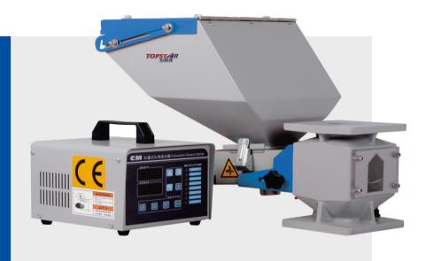
适用于新、次料、色母或添加剂等的自动比例混合。依据预先设定的比例混合,透过微电脑控制系统设定的条件自动演算出所需之转速(rpm),计量精准,其误差值±1%。该产品具备两种模式,分别适用于塑胶的注塑成型和挤出成型。螺杆直径分为12、16、20、25等多种,采用进口直流无刷马达,可演变出多种机型,提供0.08~38kgs/hr的不同输出量供客户选择。另有双色色母机,根据客户需求搭配,满足不同场合、不同领域使用。
