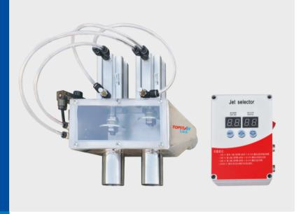
主要用于新料,次料按所需比例互相混合,并由微电脑控制两料比例,以计时器之比例差作交换吸引,将次料依比例混入新料中,确保原料输送过程畅顺及避免原料在输送过程中再次污染,本装置可减少人工成本并且减少资源浪费,从而降低成本。
