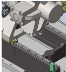
采用斜排双射移油缸及线性导轨,射胶更加精准稳定。
